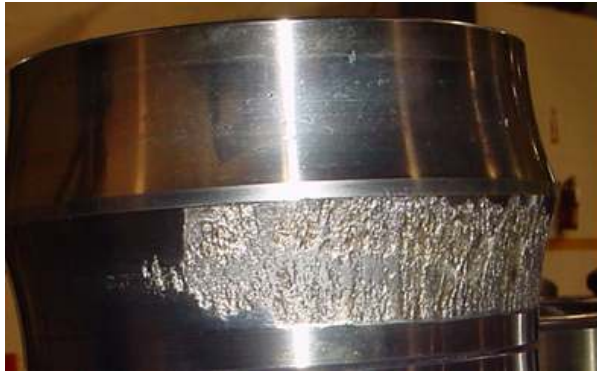
Bild 12: Schaden am Planetenlager, Innenring und Laufkörper
