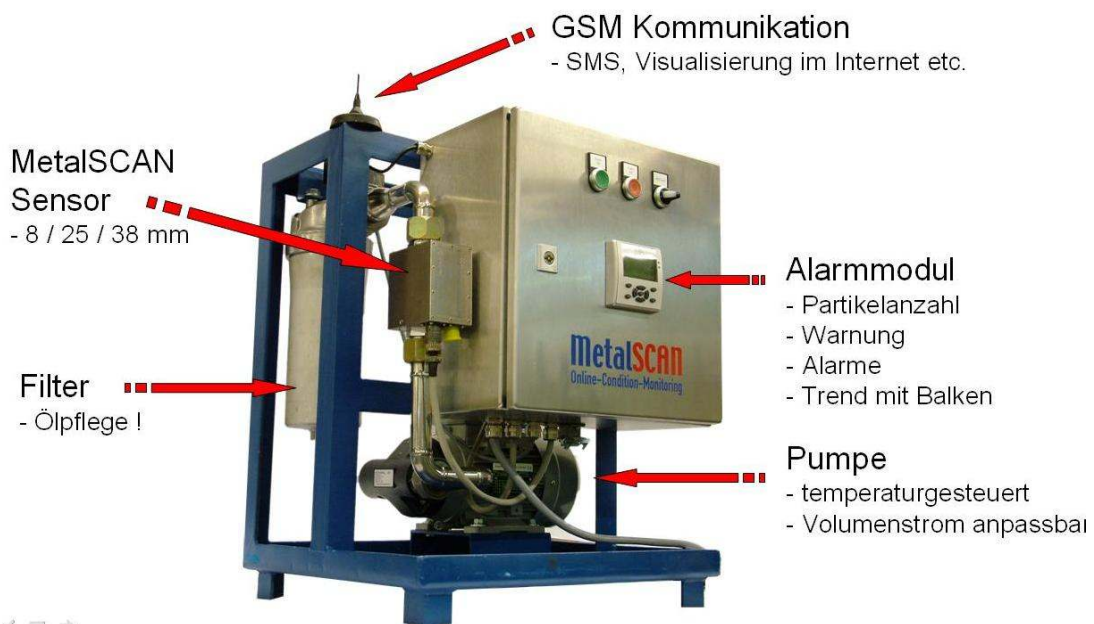
Bild 6: MetalSCAN All-In-One Filteraggregat mit Pumpe, Filter, Sensor, Alarmmodul und GSM-Kommunikation
